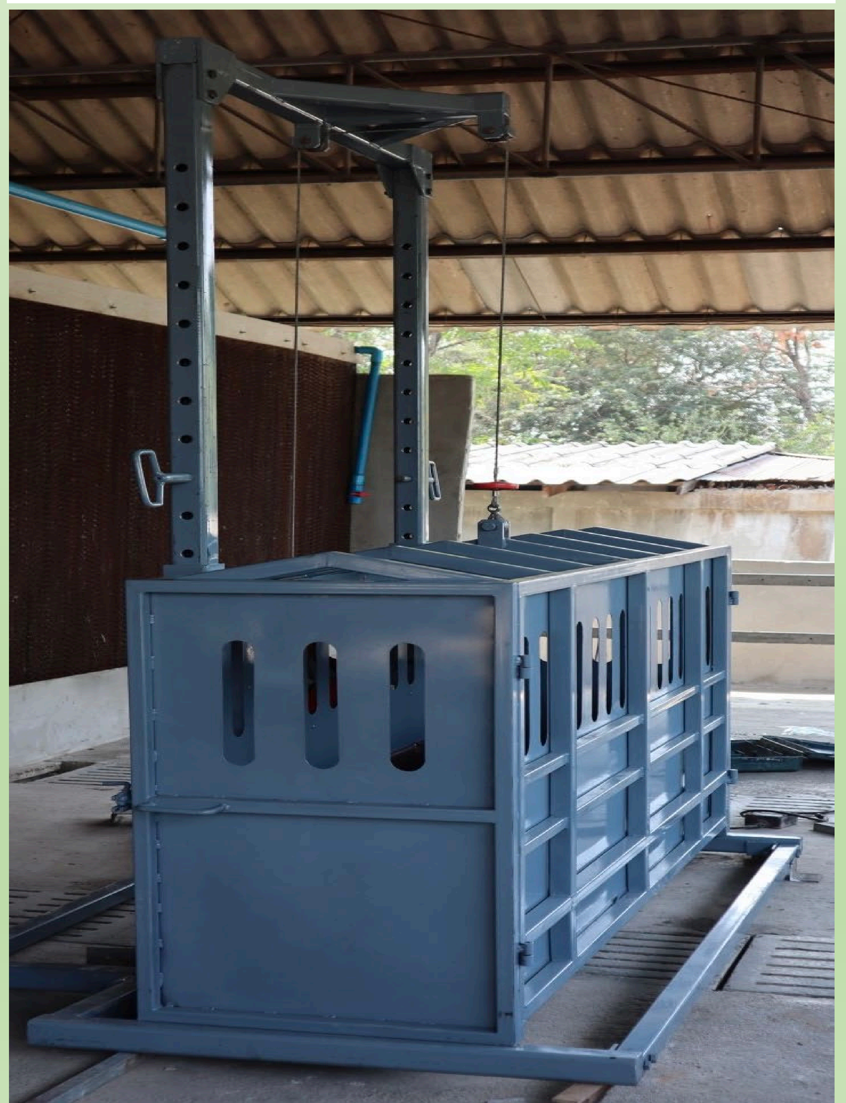
ภาพที่ 1 เครื่องบังคับสุกรแบบถอดประกอบได้ ที่ถูกติดตั้งใช้งานในฝูงแม่พันธุ์สุกร
